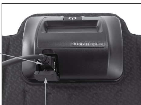
Cubierta del puerto de carga
