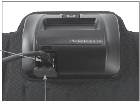
Cubierta del puerto de carga
